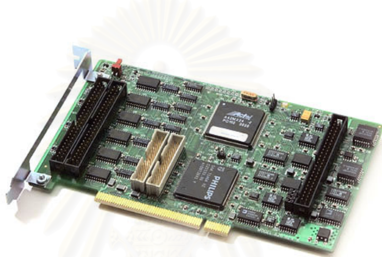
รูปที่ ข.1 แผงวงจรแปลงสัญญาณแอนะล็อกเป็นดิจิทัลและสัญญาณดิจิทัลเป็นแอนะล็อก
