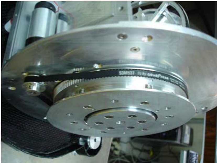
รูปที่ ก.3 ชุดเฟืองขับเคลื่อนควบคุมแนวแกน azimuth
