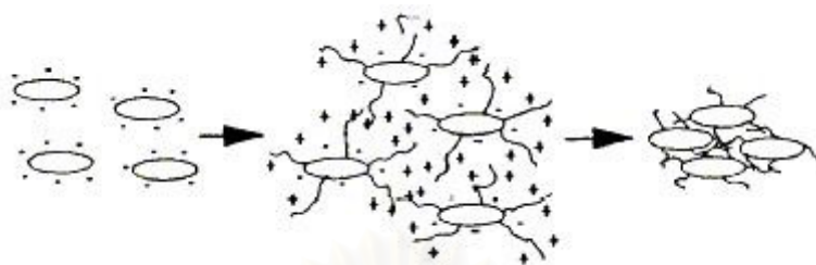
รูปที่ 2.5 บทบาทของประจุไฟฟ้า และ ECP ต่อการรวมตัวของจุลินทรีย์ (Schmidt และ Ahring , 1995)
