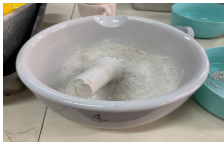
รูปที่ 3.7 ตัวอย่างโกร่งบดแร่
