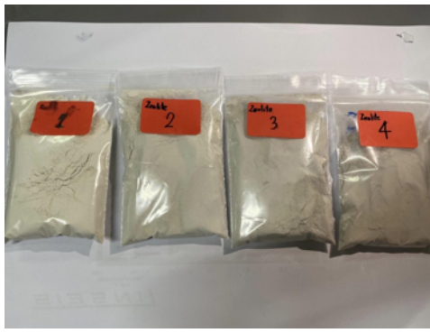
รูปที่ 3.5 ตัวอย่างแร่ซีโอไลท์ที่สังเคราะห์ได้โดยใช้สูตรที่ 2
