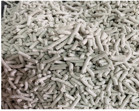
รูปที่ 3.9 ตัวอย่างทรายแมวที่ขึ้นรูปด้วยหลอดจืดยา
