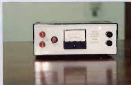
รูป 2.7 ภาพด้านหน้าของเครื่องกำเนิดความต่างสก็ร์สูง 0-3000 โวลต์
