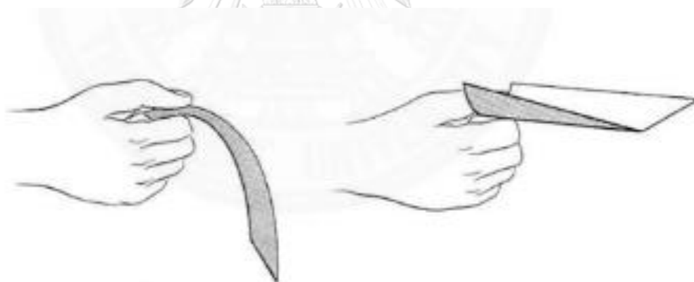
ภาพที่ 8 การใช้กระดาษแสดงหลักการของโครงสร้างต้านทานรูปทรง ที่มา: (Salvadori, M.G. 1963, อ้างถึงใน ธนัท ศักดานรเศรษฐ์, 2558)
