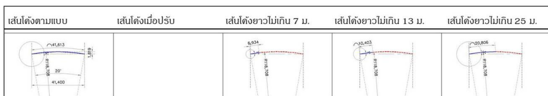
ภาพที่ 107 โครงการการศึกษาที่ 2 เส้นโค้งที่นำมาใช้วิเคราะห์การผลิตแผ่นโค้ง
