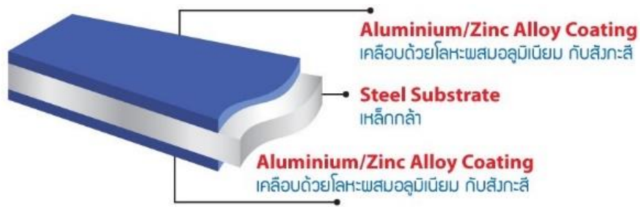
ภาพที่ 2 เหล็กเคลือบ ZINCALUME
