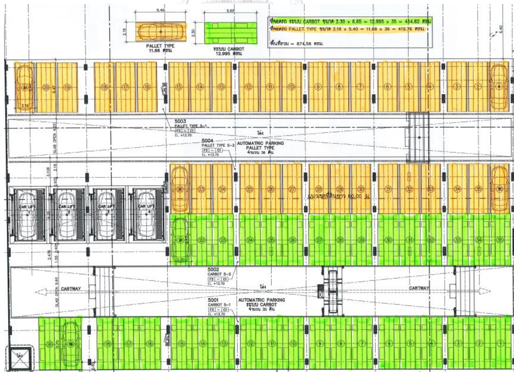
ภาพที่ 8 พื้นที่ของที่จอดรถที่คิดตามพื้นที่ช่องจอดจริง (ช่องที่ไฮไลท์สี)
