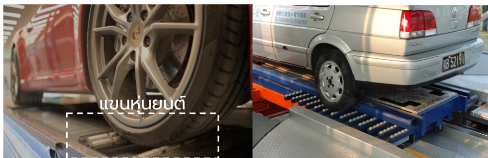
ภาพที่ 7 ลักษณะหุ่นยนต์รับส่งรถของที่จอดรถอัตโนมัติแบบไม่มีถาดรองรับ (Non-Pallet Type)
