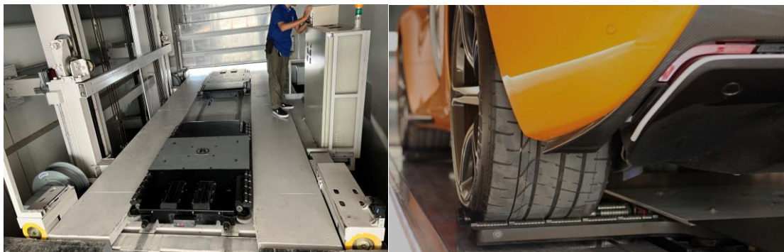
ภาพที่ 86 หุ่นยนต์คู่รองรับ-ส่งรถ (Duo-Robot) และแขนหุ่นยนต์ยกซ้อนล้อรถเพื่อนำรถไปส่งในลิฟต์หรือเก็บของจอด
