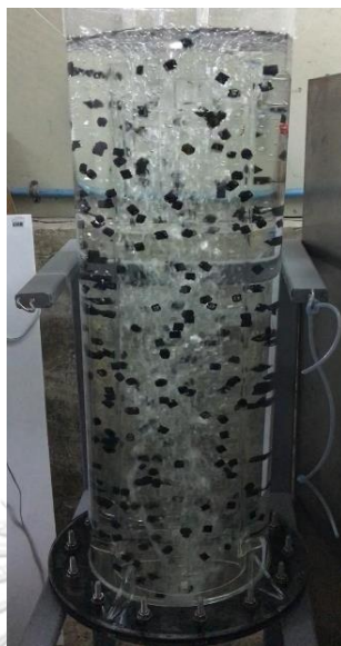
รูปที่ 4-8 การทดสอบการไหลวนของวัสดุแขวนลอยพลาสติก ในถังปฏิกรณ์ชีวภาพแบบใช้แสงชนิดอากาศยก ขนาด 60 ลิตร เมื่ออัตราการไหลของอากาศเท่ากับ 0.3 วีวีเอ็ม
