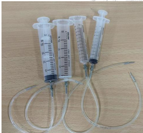
หลอดฉีดยาเชื่อมต่อกับท่อซิลิโคนและคอนเนคเตอร์
