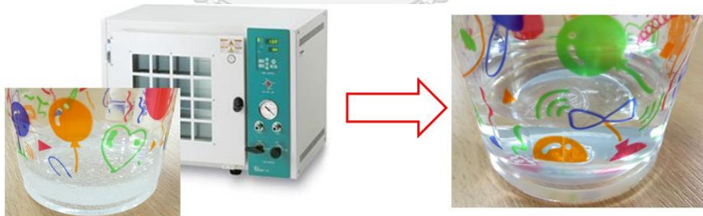
รูปที่ 4.6 การดูดฟองอากาศด้วยเครื่องอบสุญญากาศ
