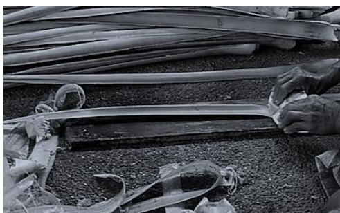
รูปที่ 2.5 การขูดแยกเส้นใยสับปะรดออกจากใบ [16]
