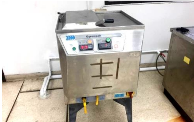
รูปที่ 3.7 เครื่องทดสอบการซักระดับห้องปฏิบัติการ (Gyro wash)
