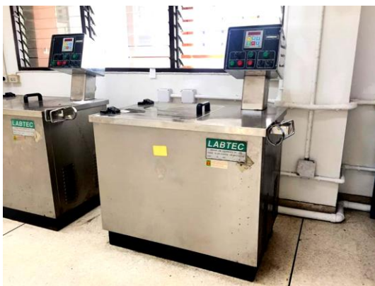
รูปที่ 3.2 เครื่องย้อมระดับห้องปฏิบัติการ
