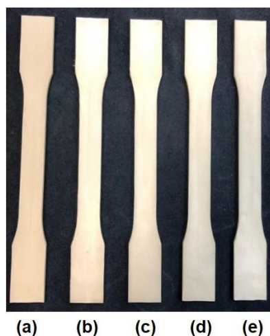
รูปที่ 4.3 ชั้นทดสอบของ 70/30 PLA/TPU คอมพอสิตด้วย OMMT/nSiO 2 ที่อัตราส่วน (phr/phr) (a) 5/0, (b) 3/2, (c) 2.5/2.5, (d) 2/3 และ (e) 5/0
