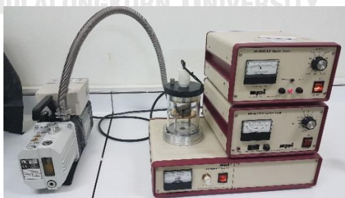
รูปที่ 3.16 อุปกรณ์เคลือบทองในระบบสุญญากาศบนพื้นผิว
