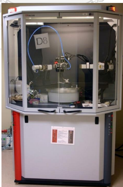
รูปที่ 3.3 ลักษณะการวัดของเครื่องเอ็กซ์เรย์-ดิฟแฟกซ์โทมิเตอร์
