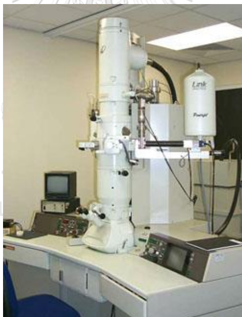
รูปที่ 3.4 กล้องจุลทรรศน์อิเล็กตรอนแบบส่องผ่าน
