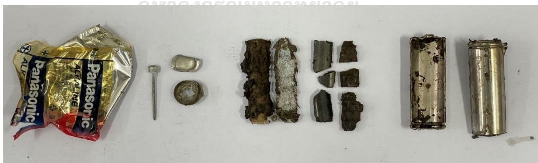
รูปที่ 4.1 แสดงส่วนประกอบของแบตเตอรี่แอลคาไลน์ (i) ปลอกพลาสติกและปลอกโลหะ (ii) แผ่นกั้นขี้ (iii) ซิงค์ออกไซด์ที่เป็นขี้แอโนด (iv) ซิงค์แมงกานีสออกไซด์และคาร์บอน เป็นขี้แคโทดและอิเล็กโทรไลต์คือโปแทสเซียมไฮดรอกไซด์
