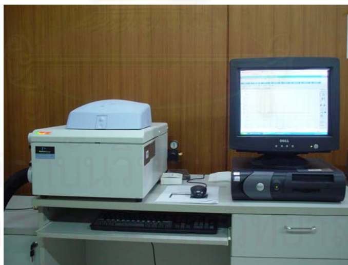
รูปที่ 3.15 เครื่องดิฟเฟอเรนเชียลสแกนนิ่งคาลอริเมทรี (differential scanning calorimeter, Perkin Elmer รุ่น Diamond DSC)
