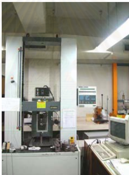
รูปที่ 3.7 เครื่องทดสอบความทนแรงดึง (universal testing machine, Lloyd รุ่น LR 100K)
