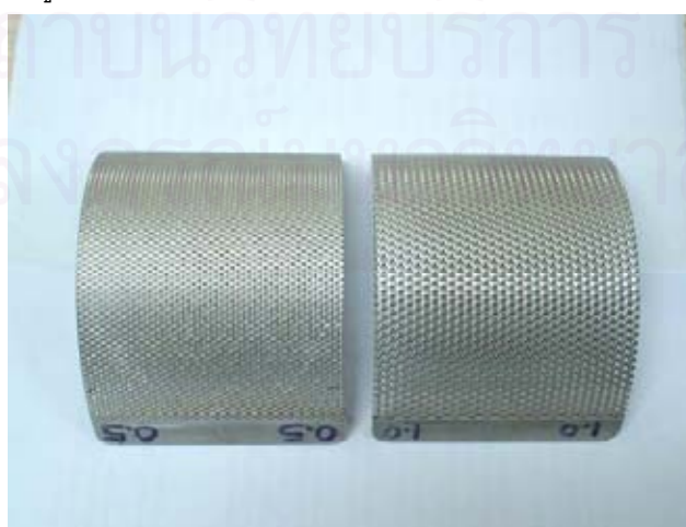
รูปที่ 3.2 ตะแกรงขนาด 0.5 และ 1.0 มิลลิเมตร
