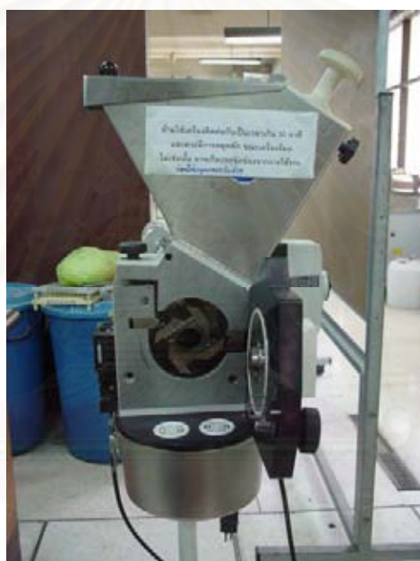
รูปที่ 3.1 เครื่องบดแบบพัลเวไรเซอร์ (pulverizer)
