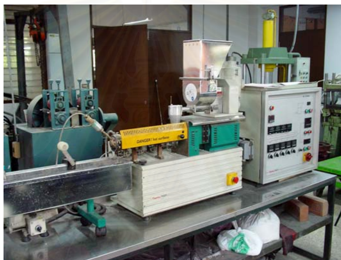
รูปที่ 3.3 เครื่องอัดรีดสกรูคู่ (twin screw extruder)
