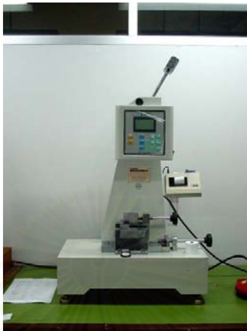
รูปที่ 3.13 เครื่องทดสอบความทนแรงกระแทก (Impact tester, Gotech Testing Machine รุ่น GT-7045-MDH)
