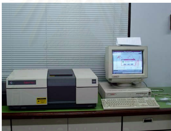
รูปที่ 3.6 เครื่องฟูริเออร์ทรานส์ฟอร์มอินฟราเรดสเปกโทรมิเตอร์ (fourier transforms infrared spectrometer รุ่น Nicolet Impact 400D)
