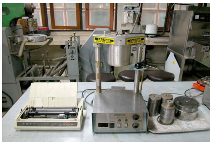
รูปที่ 3.14 เครื่องทดสอบค่าดัชนีการไหล (melt flow indexer, Kayeness รุ่น 7053)
