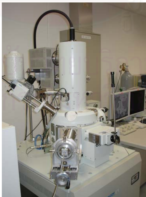
รูปที่ 2.36 กล้องจุลทรรศน์อิเล็กตรอนชนิดส่องกราด
