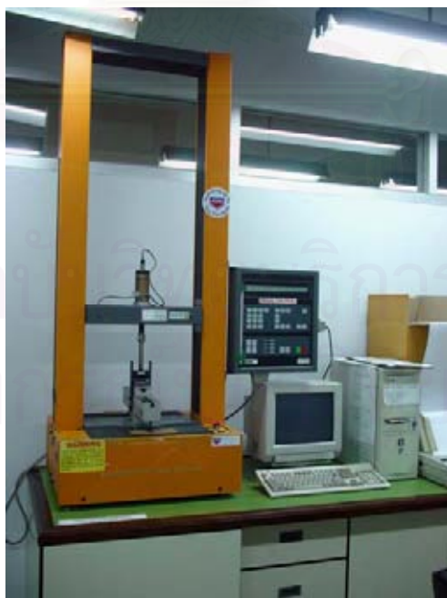
รูปที่ 3.13 เครื่องทดสอบความทนแรงดัดโค้ง (universal testing machine, Lloyd รุ่น 500)
