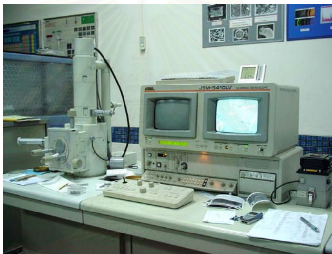
รูปที่ 3.19 กล้องจุลทรรศน์อิเล็กตรอนชนิดส่องกราด (Jeol รุ่น JSM-5410LV)
