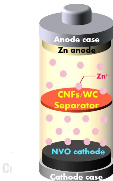
รูปที่ 62 แบบจำลองแบตเตอรี่สังกะสี-NVO (Zn|| NVO battery) ที่ใช้ตัวคั่น CNFs/WC
