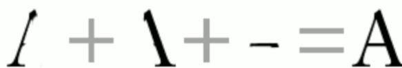
Figure 28 กระบวนการจำแนกของตัวอักษรของระบบ Feature Detection
