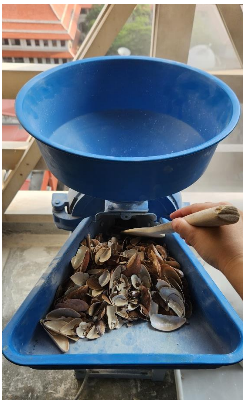
ภาพที่ 13 การบดเปลือกหอยแมลงภูให้มีขนาดเล็กลงด้วยเครื่องบด
