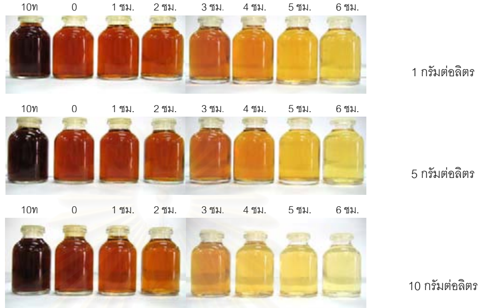
รูปที่ 4.27 ลำดับการเปลี่ยนแปลงของสีกับเวลาที่ความเข้มข้น ของไซโตเคียมคลอไรด์ 1 5 10 กรัมต่อลิตร เมื่อกระแสไฟฟ้า 7 แอมแปร์
