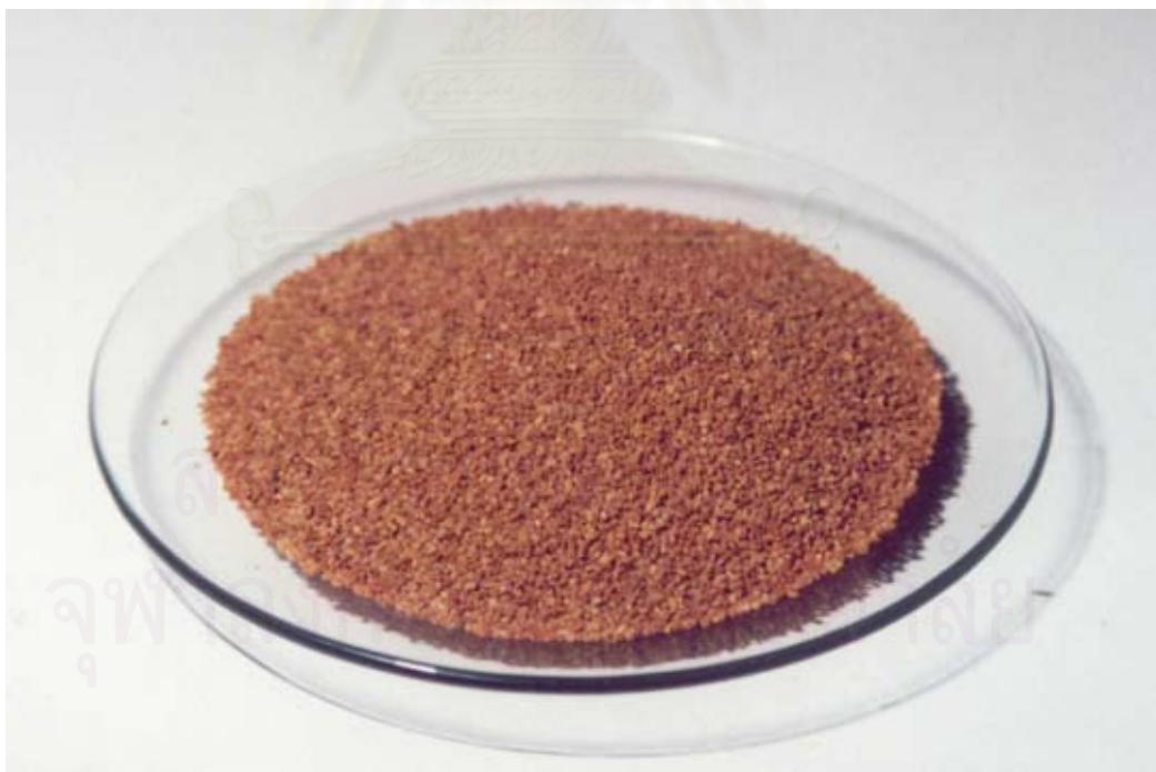
รูปที่ 4.2 ตัวอย่างทรายเคลือบเหล็กออกไซด์
