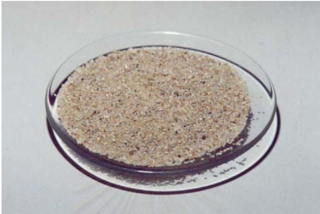
รูปที่ 4.1 ตัวอย่างทรายก่อนเคลือบเหล็กออกไซด์
