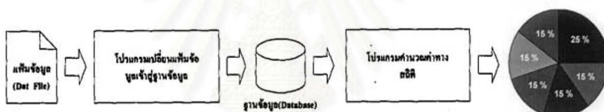
รูปที่ ค.7 ภาพโครงสร้างระบบของโปรแกรมช่วยในการหาประสิทธิภาพของ โปรแกรมตรวจพินิจออลูมินัม
