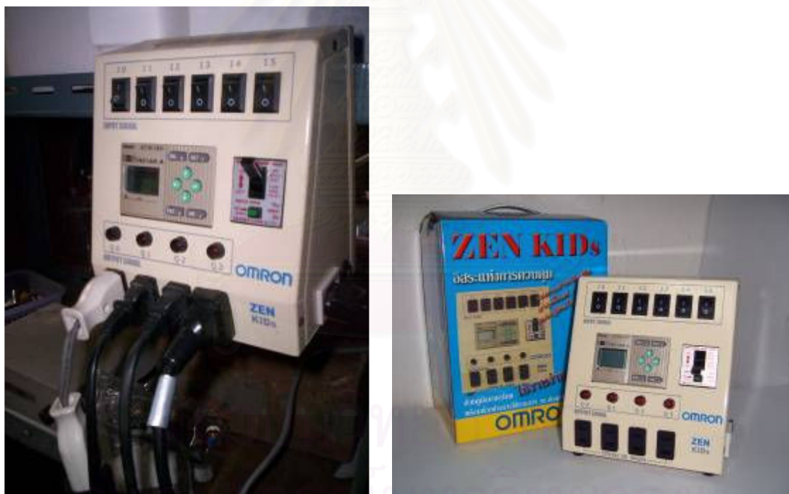
รูปที่ ก.5 เครื่องควบคุมระบบการทำงาน (PLC)
