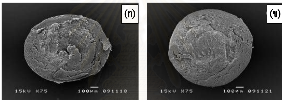
รูปที่ 4.17 ภาพถ่ายผ่าครึ่งของเม็ดตะกอนจุลินทรีย์ ก่อนและหลังการทดลองด้วยเครื่อง SEM
