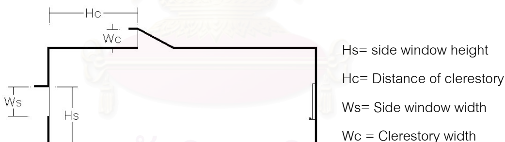
ภาพที่ 5.3 ภาพแสดงรูปตัด และสัญลักษณ์บอกตำแหน่งของช่องแสงภายในห้องเรียน
