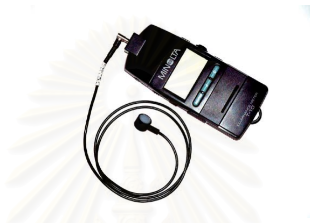
ภาพที่ 3.11 เครื่องมือที่วัดปริมาณแสงสว่าง Illumination Meter (Minolta T -10)
