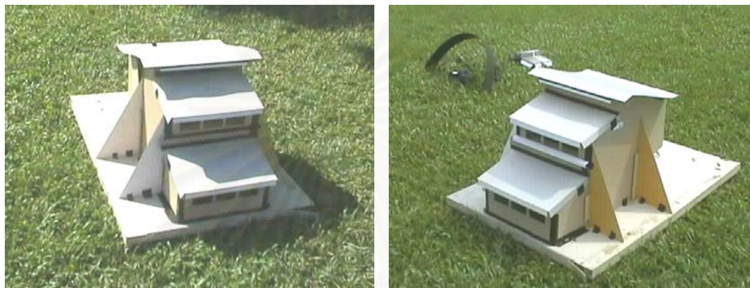
ภาพที่ 5.8 ห้องจำลองอาคารโรงเรียนต้นแบบภาคตะวันออกเฉียงเหนือที่ใช้สำหรับวัดค่าความส่องสว่าง
