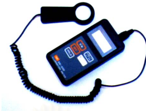
ภาพที่ 3.12 เครื่องมือที่วัดปริมาณแสงสว่าง Illumination Meter (Minolta - Lux Meter)
