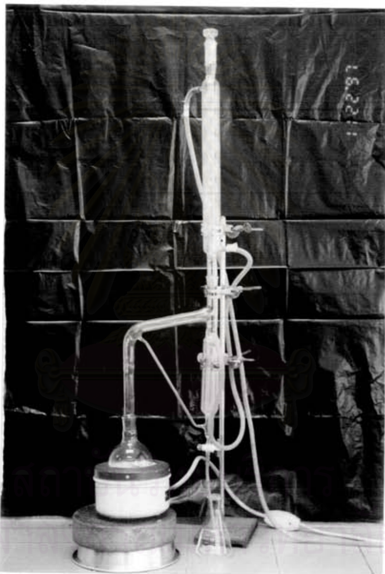
รูป ค.1 ชุดเครื่องมือที่ใช้ในการกลั่นเพื่อวิเคราะห์กรดไฮโดรไซยานิก
