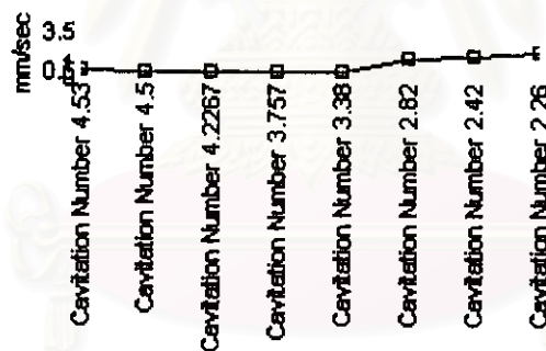
รูปที่ 5-133 แสดง Amplitude ที่ 7250 CPM ของออร์ฟิต B=0.4 ที่ระดับความรุนแรงต่างกัน
