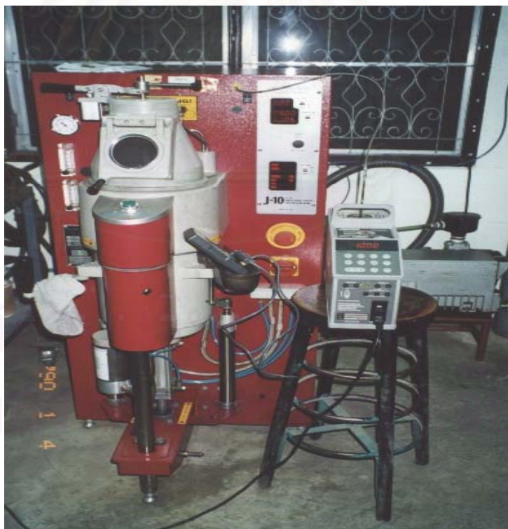
รูปที่ 3.7 เครื่องมือวัดอุณหภูมิมาตรฐาน (ขณะวัดค่าความผันแปรในตู้อบแบบพิมพ์ป้อน ที่ 650 °C แต่อ่านค่าอุณหภูมิได้ 657 °C)
