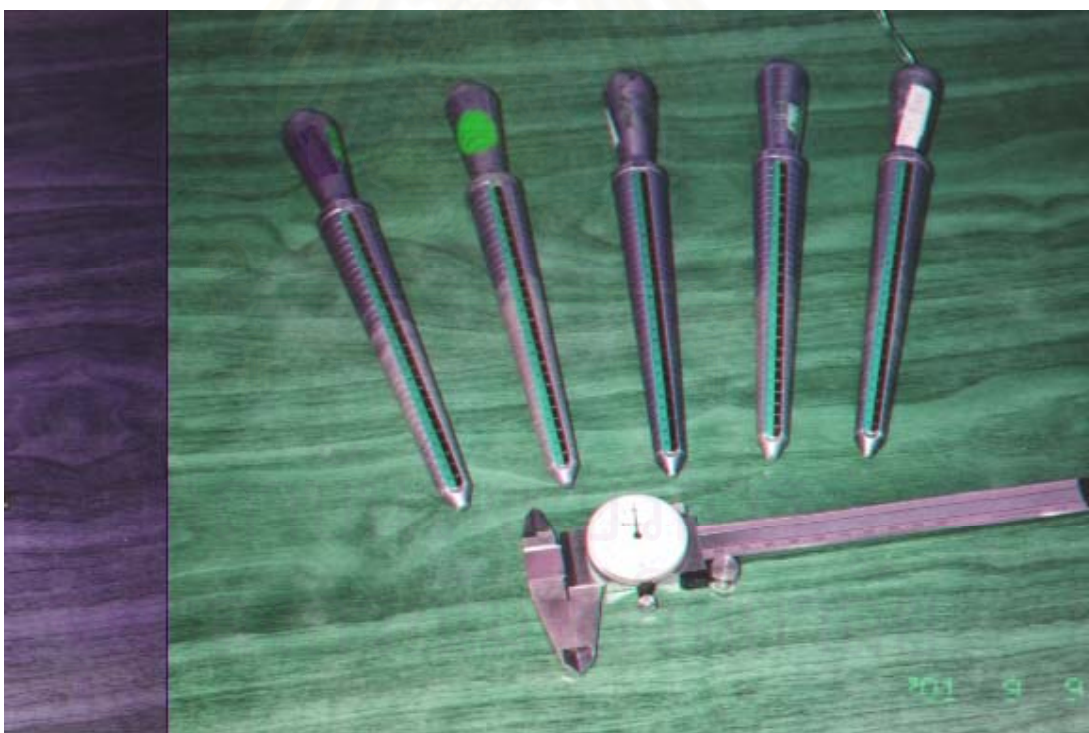
รูปที่ 3.10 การสอบเทียบเครื่องวัดเส้นผ่าศูนย์กลางตัวเรือนแหวน ด้วย เวอร์เนียมาตรฐาน
