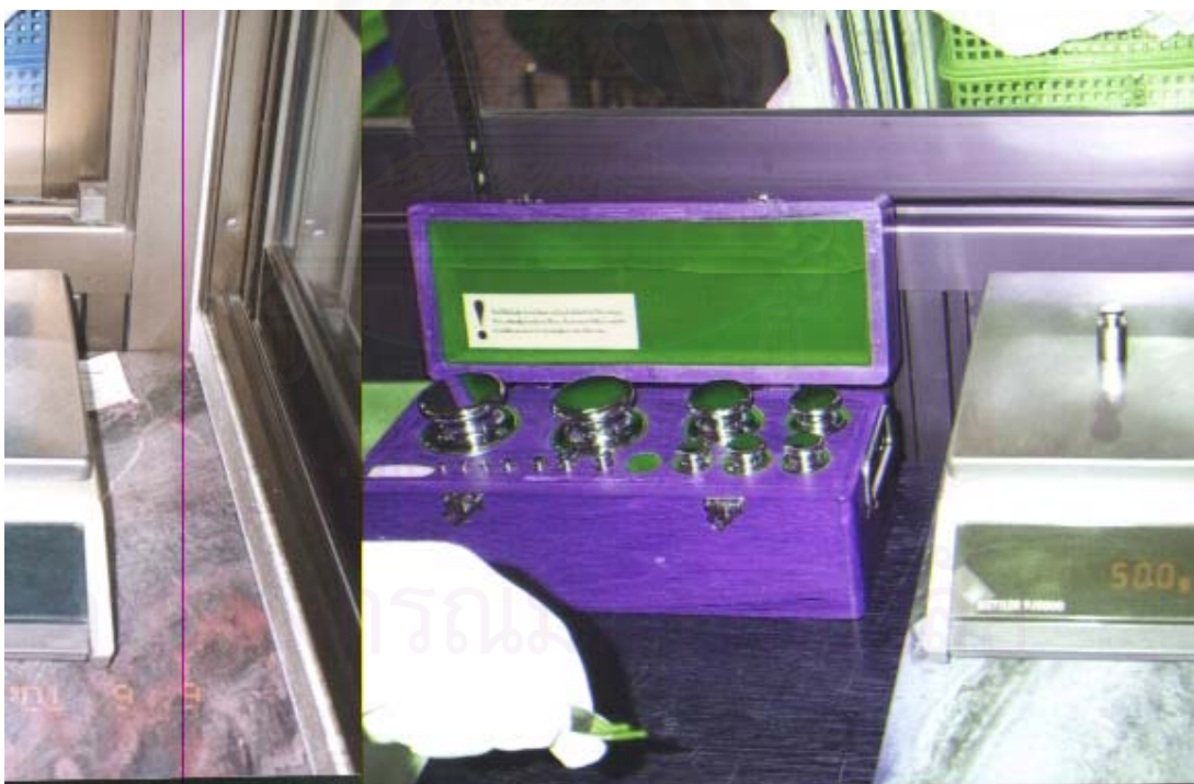
รูปที่ 3.1 การสอบเทียบเครื่องชั่ง ที่ 20 กรัม ด้วยตุ้มน้ำหนักมาตรฐาน
