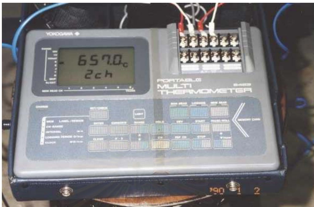
รูปที่ 3.7 เครื่องมือวัดอุณหภูมิมาตรฐาน (ขณะวัดค่าความผันแปรในตู้อบแบบพิมพ์ป้อน ที่ 650 °C แต่อ่านค่าอุณหภูมิได้ 657 °C)
