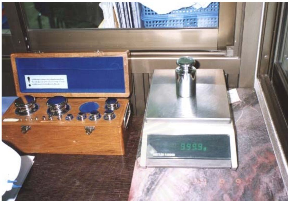
รูปที่ 3.3 การสอบเทียบเครื่องชั่ง ที่ 1000 กรัม ด้วยตุ้มน้ำหนักมาตรฐาน
