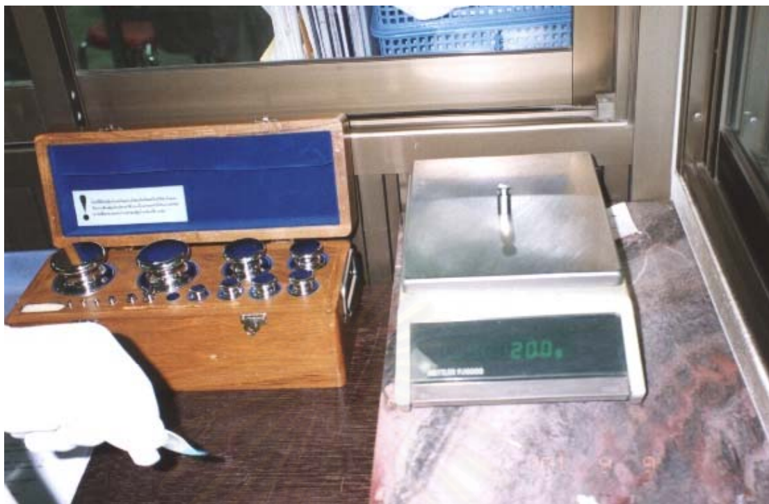
รูปที่ 3.1 การสอบเทียบเครื่องชั่ง ที่ 20 กรัม ด้วยตุ้มน้ำหนักมาตรฐาน
