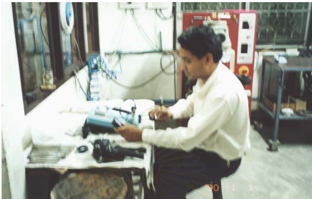
รูปที่ 3.9 การทดลองหาค่าความผันแปร เครื่องมือวัดความดัน(สูญญากาศ)
