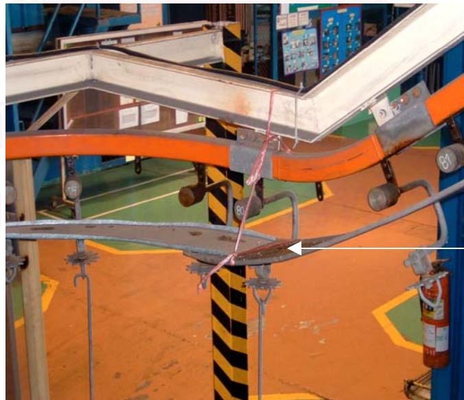
รูปที่ 5.3 แสดงถาดรองรางเหล็กแขวนสาย conveyor ป้องกันเศษสนิมและน้ำมันหล่นใส่ชิ้นงาน
