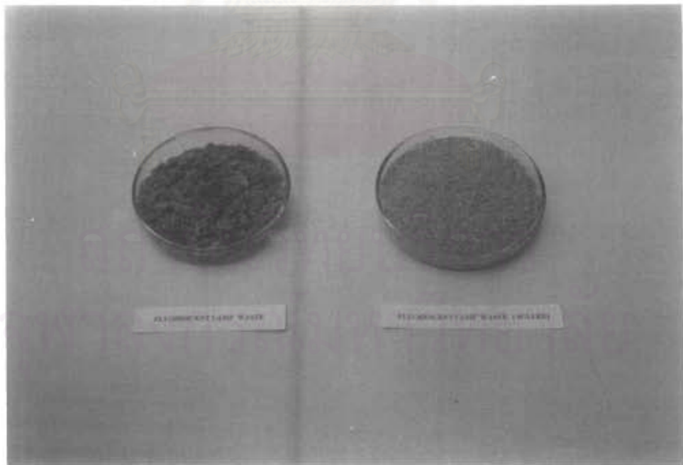
รูปที่ 4.6 ภาพซ้าย แสดงตะกอนโลหะหนักจากการชะล้างกากหลอดฟลูออเรสเซนต์ (ก่อนบด) ภาพขวา แสดงตะกอนโลหะหนักจากการชะล้างกากหลอดฟลูออเรสเซนต์ (หลังบด)
