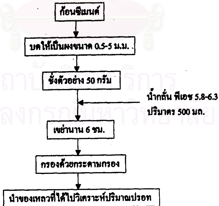
รูปที่ 4.14 แสดงการทดสอบการชะละลายของปรอท (กรมโรงงานอุตสาหกรรม, 2531)
