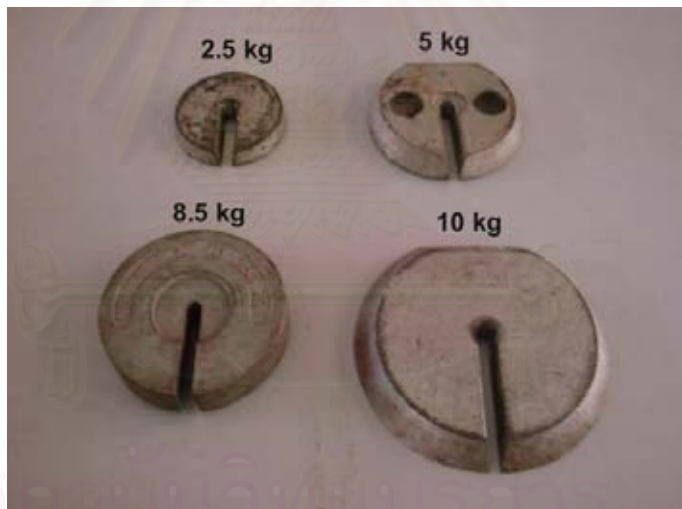
รูปที่ ข10 ต้มน้ำหนักมาตรฐาน
