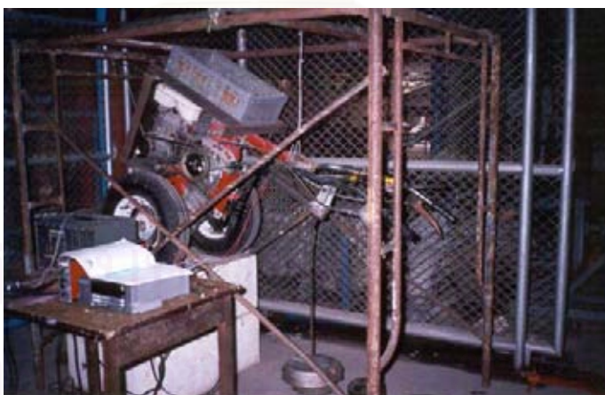
รูปที่ ง2 การสอบเทียบอุปกรณ์วัดแรงรูปตัว L ขณะเปลี่ยน มุมเอียงของการถ่วงน้ำหนัก
