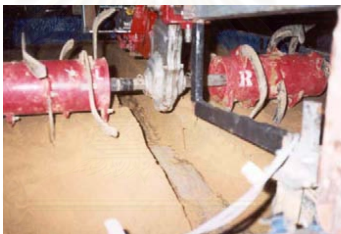
รูปที่ 6.5 แนวนร่องทรายทางวิ่งของอุปกรณ์วัดแรงรูปตัว L
