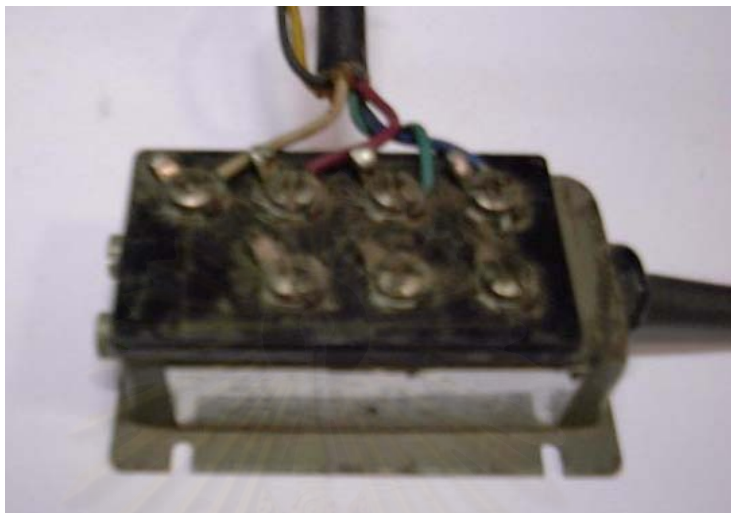
รูปที่ ๘ Bridge box ที่ใช้กับ Load cell
