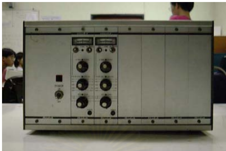
รูปที่ ค2 Strain amplifier ที่ใช้กับ Strain gage ตำแหน่งที่ 1
