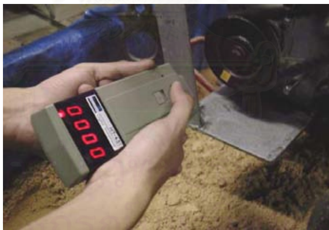
รูปที่ 6.7 การวัดความเร็วรอบเครื่องยนต์
