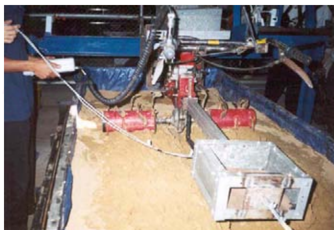
รูปที่ 6.10 การวัดการสันสะเทือนที่คันมือถือด้านซ้ายของรถไถพรวน
