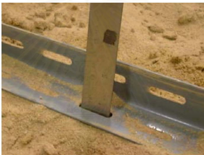
รูปที่ 6.12 การวัดความลึกการพรวนทราย
