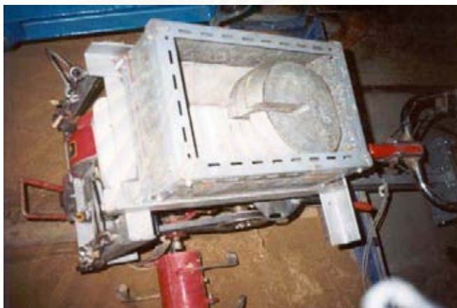
รูปที่ 6.13 การถ่วงน้ำหนักรถไถพรวนด้านหน้า
