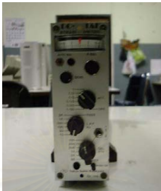
รูปที่ ค4 Strain amplifier ที่ใช้กับ Strain gage ตำแหน่ง 2
