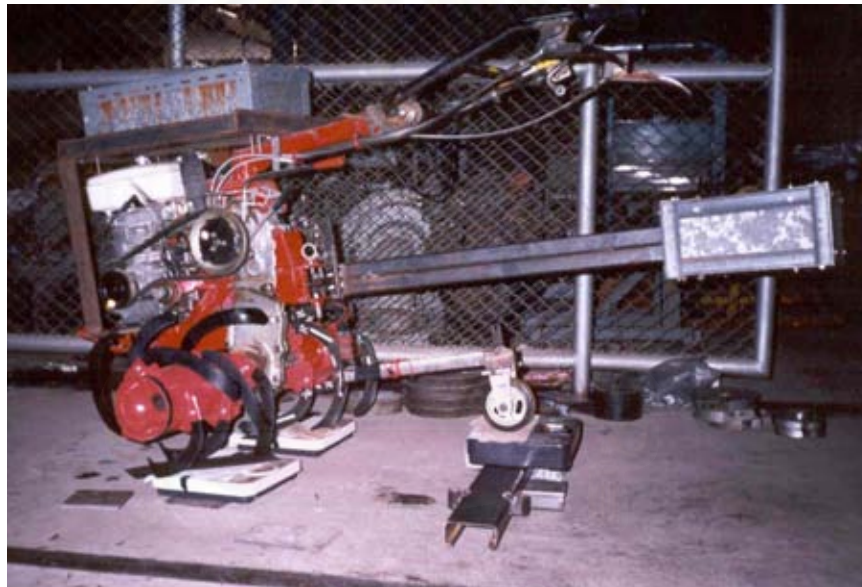
รูปที่ จ6 การหาจุดศูนย์ถ่วงของรถไถพรวนกรณีจัด ให้แท่นเครื่องเอียงทำมุมกับแนวระดับ
