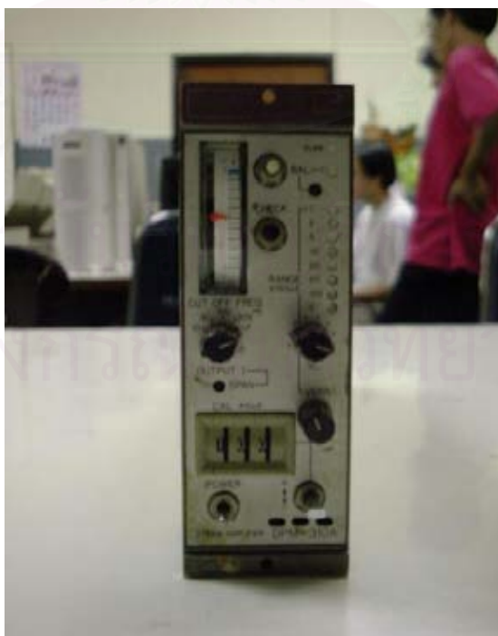
รูปที่ ๓7 Strain amplifier ที่ใช้กับ Load cell
