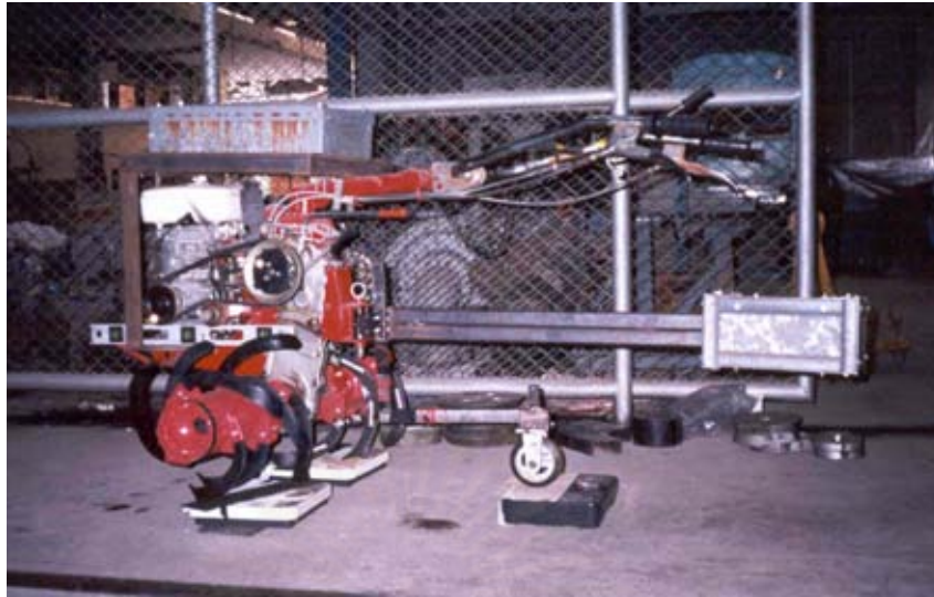
รูปที่ จ5 การหาจุดศูนย์ถ่วงของรถไถพรวนกรณี จัดให้แท่นเครื่องอยู่ในแนวระดับ
