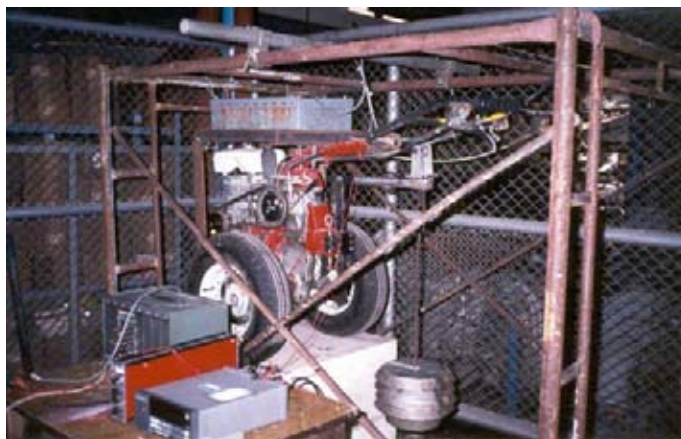
รูปที่ ง1 การสอบเทียบอุปกรณ์วัดแรงรูปตัว L ขณะถ่วงน้ำหนัก ที่ 0 องศา
