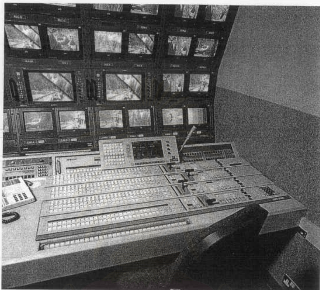
ภาพประกอบที่ 22 เครื่องผสมภาพ (switcher) ที่ใช้ในงานควบคุมการออกอากาศ
