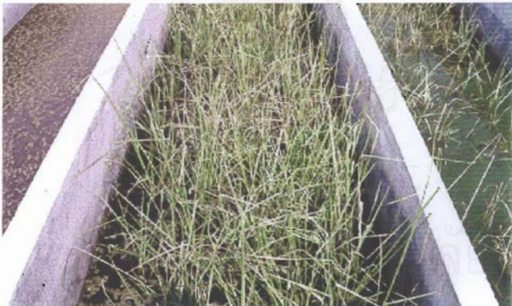
รูปที่ ค.3 การเจริญเติบโตของหน้างปลูกทั้งสองสายพันธุ์ ที่ระดับน้ำ 0.15 เมตร ที่ระยะเวลาการทดลอง 50 วัน
