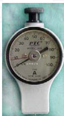
รูปที่ 3.11 เครื่องวัดความแข็งผิวดูโรมิเตอร์ แบบ เอ รุ่น 408 และ ขาตั้ง รุ่น 471
