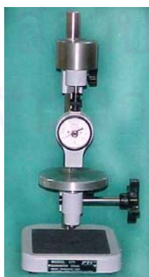
รูปที่ 3.11 เครื่องวัดความแข็งผิวดูโรมิเตอร์ แบบ เอ รุ่น 408 และ ขาตั้ง รุ่น 471
