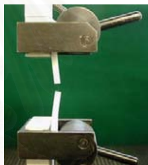
รูปที่ 3.18 การยืดชิ้นทดสอบ และชิ้นทดสอบที่ขาดออกจากกัน
