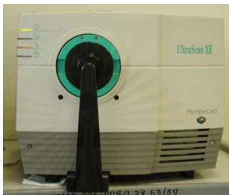
รูปที่ 3.12 เครื่องวัดสีอัลตราสแกน เอ็กซ์ ซี
