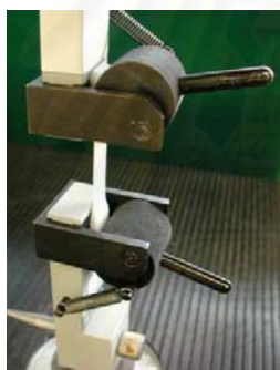
รูปที่ 3.18 การยืดชิ้นทดสอบ และชิ้นทดสอบที่ขาดออกจากกัน
