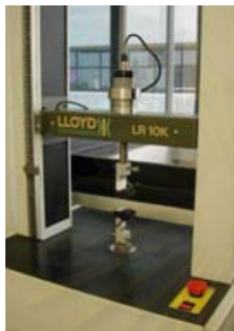
รูปที่ 3.10 เครื่องทดสอบยูนิเวอร์ซัลลอยด์ รุ่น แอลอาร์ 10 เค และ แขนจับแบบหนีบ
