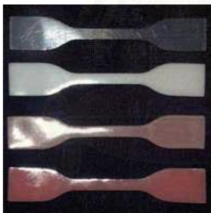
รูปที่ 3.14 ชิ้นทดสอบรูปดัมเบลล์ แบบที่ 2 ตาม มาตรฐาน ไอเอสโอ 37
