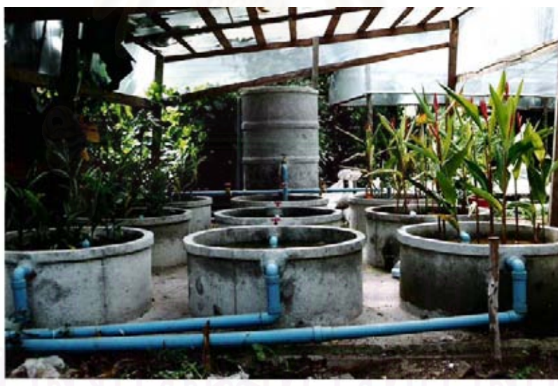
รูปที่ 3.2 ระบบบึงประดิษฐ์ที่ใช้ในการทดลอง
