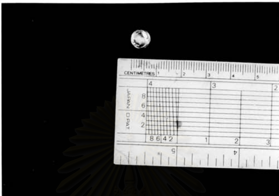
รูปที่ 20 ก. งานโต้วอย่างขนาด 10 ไมโครติตร (บน) ข. เครื่องดีฟเฟอเรนเชียล สแกนนิ่ง คาลอริมิเตอร์ขณะทำการทดสอบ (ล่าง)
