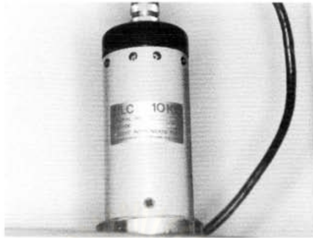
รูปที่ 36 แสดงตุ้มน้ำหนัก (Load cell) ขนาด 10 กิโลนิวตัน
