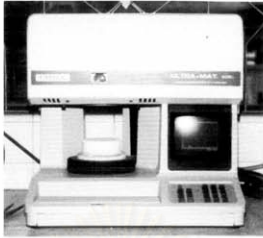
รูปที่ 24 แสดงเตาเผาฟอร์ชเลน ยี่ห้อ ULTRA-MAT CDF
