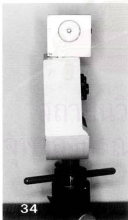
รูปที่ 34 แสดง Fixed head ที่ใช้จับชิ้นงานซึ่งบรรจุในท่อ PVC รูปที่ 35 แสดง Cross head เป็นส่วนของเครื่องมือซึ่งเคลื่อนที่ และทำให้เกิดแรงต่อวัสดุ
