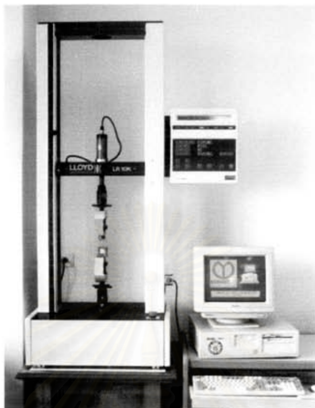
รูปที่ 33 แสดงเครื่องทดสอบทั่วไป Lloyd Model LR 10K
