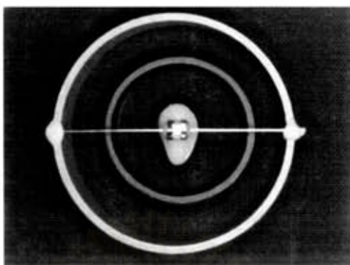
รูปที่ 45 แสดงการจัดตำแหน่งของชิ้นพอร์ชเลนที่จะฝังในท่อ PVC
