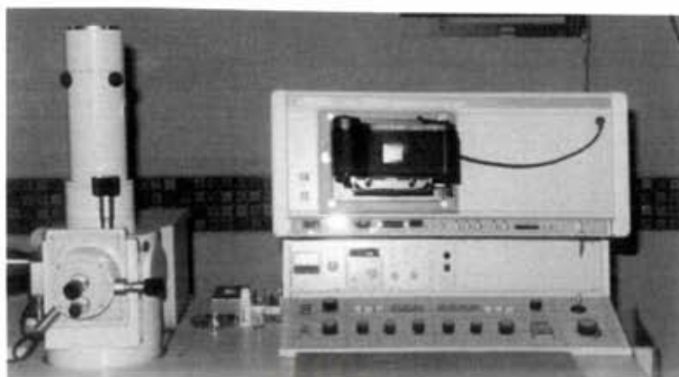
รูปที่ 39 แสดงกล้องจุลทรรศน์อิเล็กตรอนแบบส่องกราด
