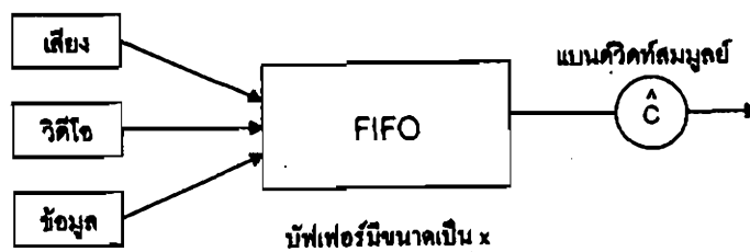
รูปที่ 2.5 แหล่งกำเนิดวิวิธพันธุ์ที่มีมิติเพลกซ์กันในรูปแบบจำลองของไหล (fluid model)
