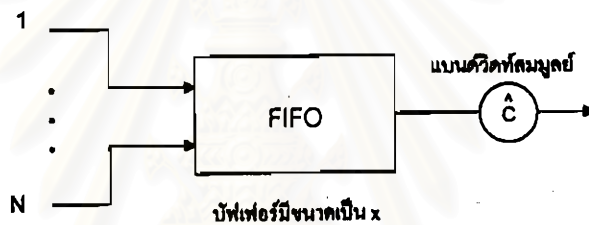
รูปที่ 2.2 แหล่งกำเนิด N แหล่งที่มีลักษณะร่วมกันในแบบจำลองของไหล (Fluid Model)
