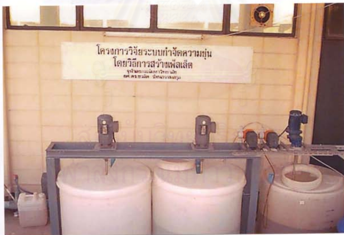
รูปที่ ๑ 3 ถังผสมสารเคมีและอุปกรณ์กวนสารเคมี
