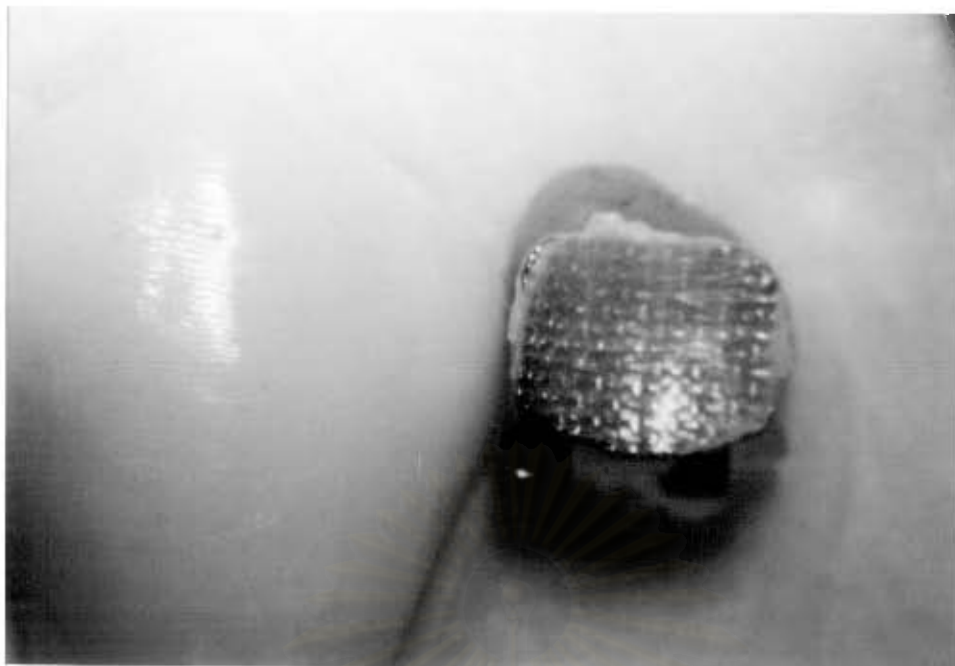
ภาพที่ 32 แสดงบริเวณที่เกิดความล้มเหลวของวัสดุยึดติด (ARI=0)
