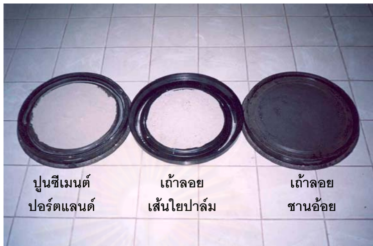
รูปที่ 3.1 ปูนซีเมนต์ปอร์ตแลนด์ เถ้าลอยเส้นใยปาล์มและเถ้าลอยชานอ้อย
