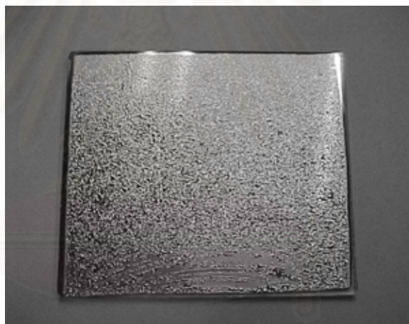
รูปที่ 5.2 ลักษณะของฟิล์มบางโมลิบดีนัมที่ลอกออกจากกระจก ผิวฟิล์มแตก ขรุขระ
