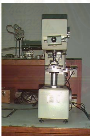
รูปที่ 4.1 เครื่อง HV – 5 สำหรับวัดความแข็งของชิ้นงาน
