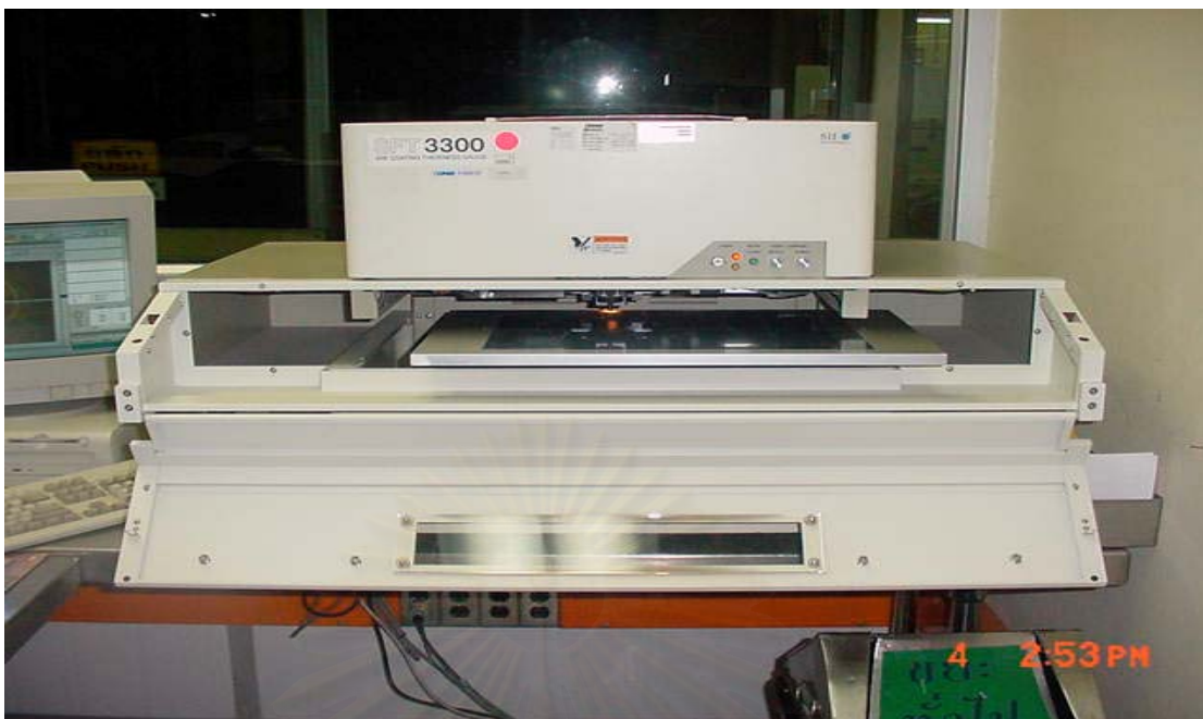
รูปที่ 3.9 แสดงเครื่อง X-Ray fluorescence ใช้ในการวัดความหนาผิวเคลือบ
