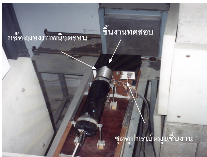
รูปที่ 4.1 ระบบเก็บข้อมูลภาพถ่ายด้วยนิวตรอนโดยเทคนิคโทรทัศน์ สำหรับส่วนที่ติดตั้งภายในห้องกำบังรังสี
