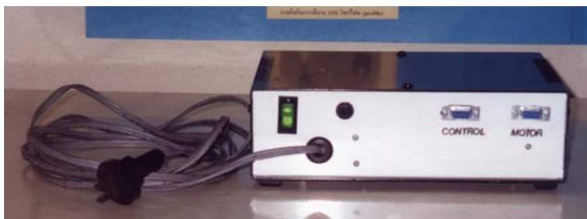
รูปที่ 3.17 ด้านหน้าของอุปกรณ์เชื่อมต่อโยงสัญญาณระหว่างวงจรขับเคลื่อนมอเตอร์ กับชุดอุปกรณ์หมุนชิ้นงานตัวอย่าง
