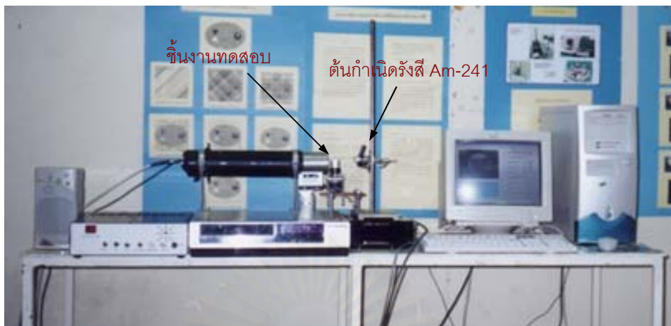
รูปที่ 4.9 การจัดระบบเก็บข้อมูลด้วยรังสีแกมมาโดยใช้กล้องมองภาพนิวตรอน
