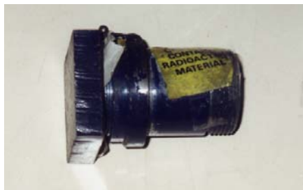
รูปที่ 3.3 ภาพขณะบรรจุต้นกำเนิดรังสี อเมริเซียม-241 (Am-241)
