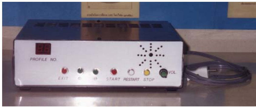
รูปที่ 3.15 ด้านหน้าของอุปกรณ์เชื่อมโยงสัญญาณระหว่างไมโครคอนโทรลเลอร์กับวงจรตีปึงมอเตอร์
