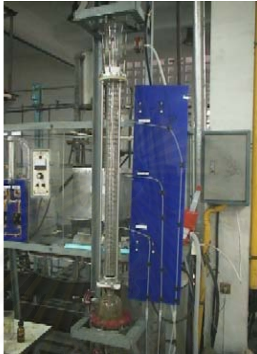
รูปที่ 3.4 เครื่องสกัดแบบจวนหมุนที่ตำแหน่งการติดตั้งสารทดลองต่าง ๆ
