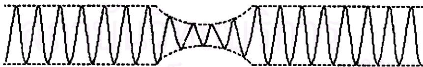
รูปที่ 2.9 แสดงสัญญาณ NMR มอดูเลทแบบ AM กับความถี่สูง (จำลอง)
