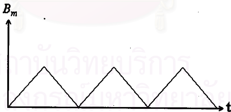
รูปที่ 2.5 แสดงการกวาดขึ้นลงของสนามแม่เหล็กขนาดเล็ก B_m ซึ่งใช้มอดูเลทกับสนามแม่เหล็กสถิต B เพื่อให้สนามแม่เหล็กกวาดผ่านจุดเรโซแนนซ์หรือผ่านจุดที่สนามแม่เหล็กมีค่า B_0 ในรูป t เป็นเวลา
