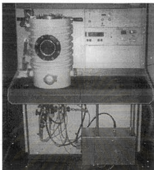
รูปที่ 5.9 ภาชนะสุญญากาศและแผงควบคุมการทำงานของระบบสุญญากาศ
