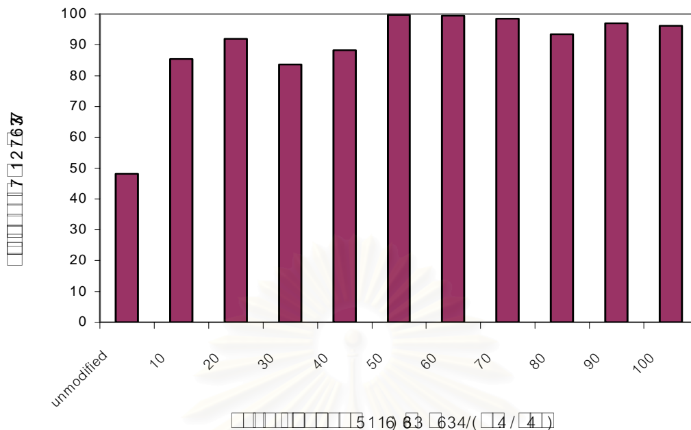
รูปที่ 4.9 ค่าร้อยละการฟีนิกสีของผ้าย้อมโดยใช้ Bayhibit ความเข้มข้นต่างๆ เทียบกับผ้าย้อมที่ไม่ใช้ Bayhibit
