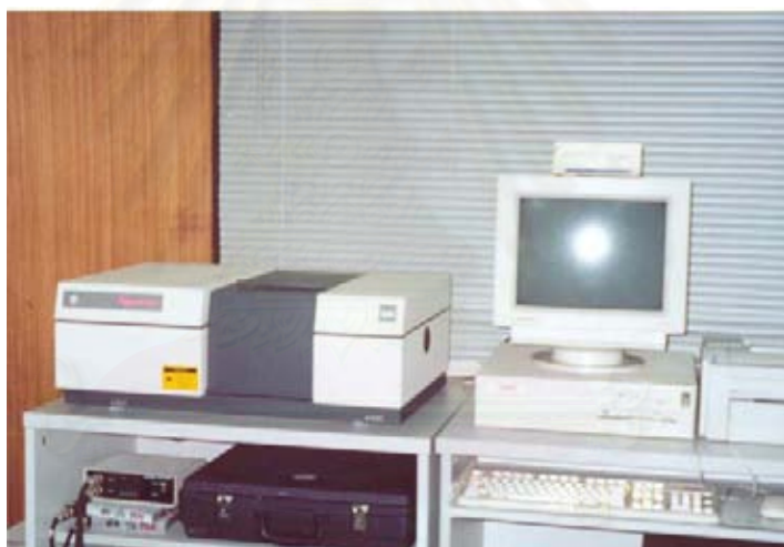
รูปที่ 3.4 เครื่องฟูรีเออร์ทรานฟอร์ม อินฟราเรดสเปกโทรโฟโตมิเตอร์ (FT-IR spectrophotometer)
