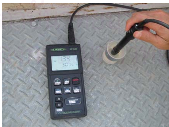
รูป ง-16 การวัดและอ่านค่าความเค็มจากตัวอย่างน้ำ ของเครื่อง Conductivity Meter
