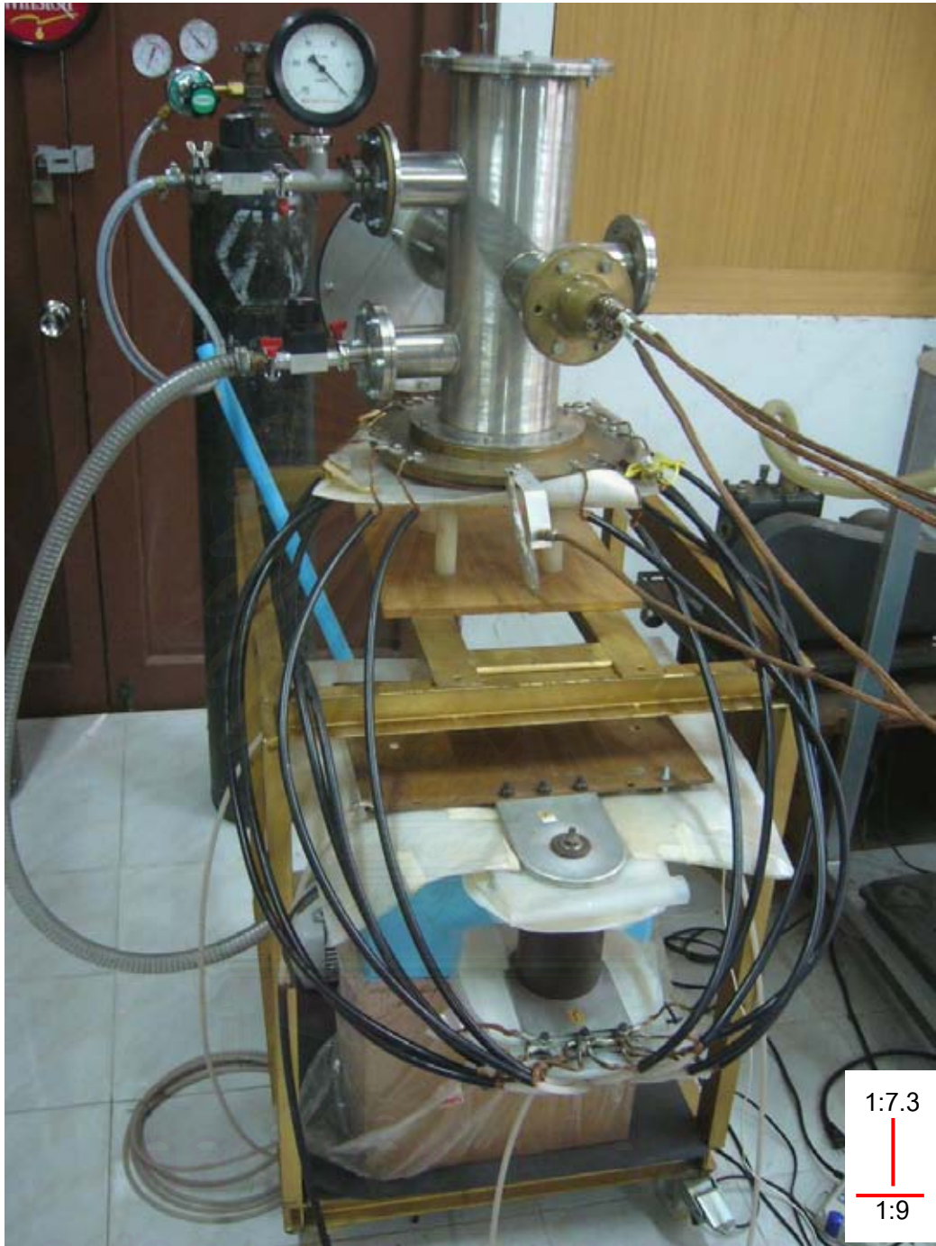
รูปที่ 4.2 ภาพถ่ายเครื่องพลาสมาไฟกัสที่ใช้ในงานวิจัย
