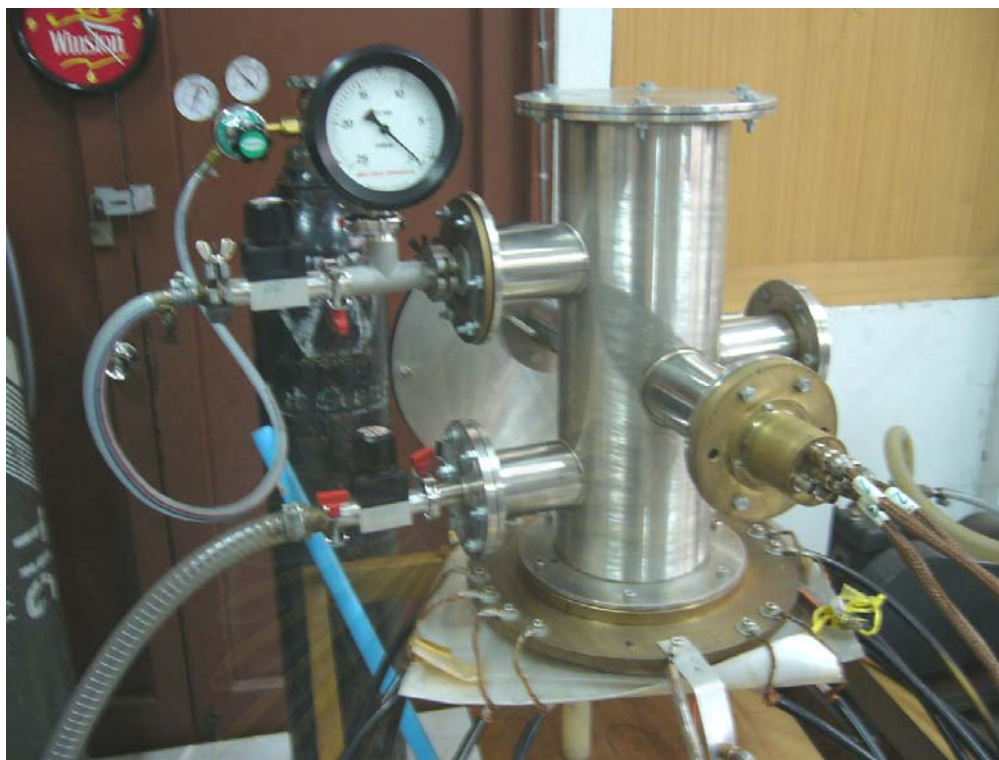
รูปที่ 5.9 ภาพถ่ายลักษณะการติดตั้งสเปกโตรมิเตอร์รังสีเอกซ์แบบไดโอด 5 ช่อง กับเครื่องพลาสมาไฟกัสที่ใช้ในการทดลอง
