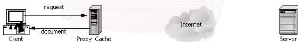
รูปที่ 2.3 ขั้นตอนการทำงานของเว็บแคช เมื่อพบเอกสารที่ต้องการภายในแคช
