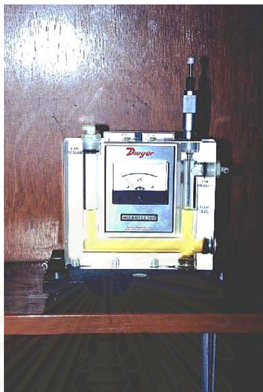
รูปที่ 4 - 9 : แสดง Microtector ที่ใช้ในการทดลอง
