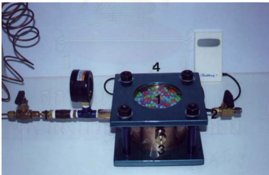
รูปที่ 4.3 อุปกรณ์ที่สร้างขึ้นเพื่อใช้ในการทดลองหาค่าความสามารถในการซึมผ่านของก๊าซผ่านฟิล์มพอลิเมอร์
