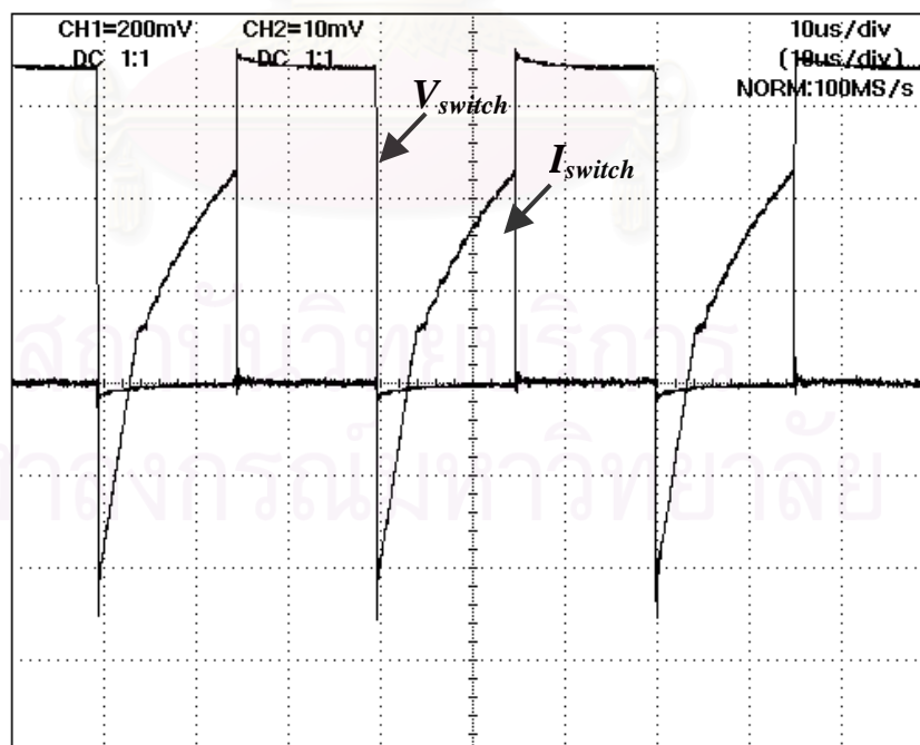
รูปที่4.44 แรงดันและกระแสที่สวิตช์ (100 V/DIV 1A/DIV) ที่แรงดันไฟตรง 350 VDC
